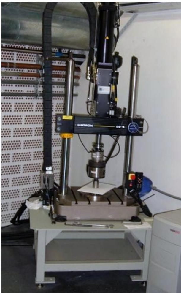
Figura 3. Ensayo dinámico de almohadillado.
